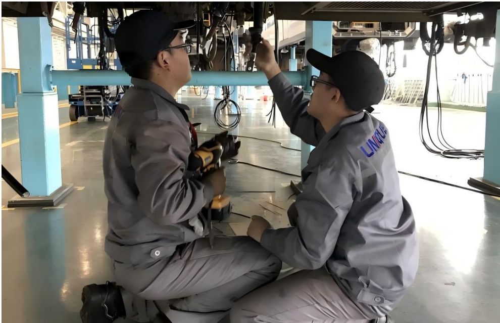
图 5-1 学生在天津电力机车有限公司轨道进行车辆走行部电缆线检修
